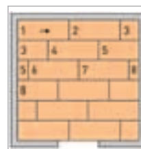
Shema za polaganje 1 – polaganje proti vratni odprtini
