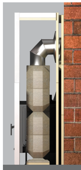
Prikaz preseka tri slojne konstrukcije zadnje stene
