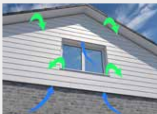
zeleno: odvod zraka modro:: zajem zraka
