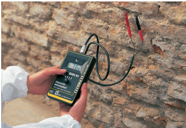
Meritev vlažnosti s higrometrom
