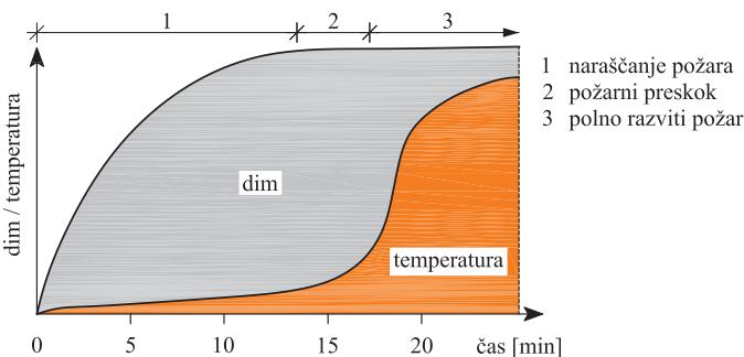
Slika 53: Razvoj dima in temperature pri požaru
