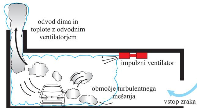
Slika 203: Shema impulznega odvoda dima in toplote
