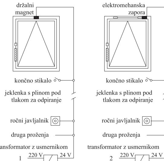
Slika 210: Najenostavnejša izvedba ročnega električnega daljinskega odpiranja oken, levo sistem z držalnim magnetom, desno z elektromehansko zaporo.
