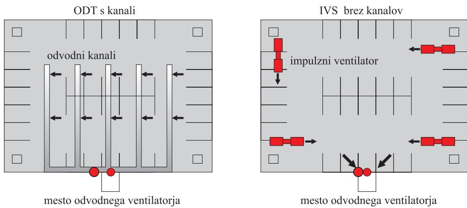
Slika 202: ODT s kanali in IVS brez kanalov
