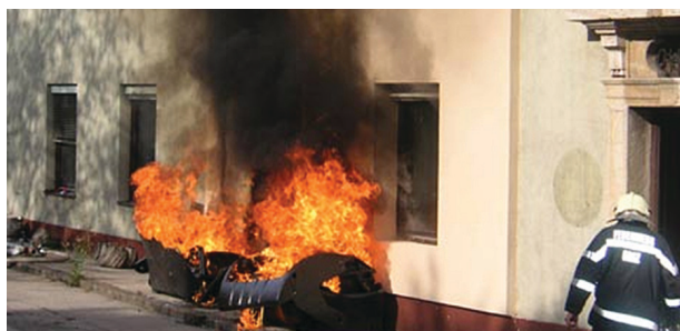
Slika E.5: Preskus s požarom zabojnika za smeti ob fasadi z gorljivo izolacijo (Vir: http://www.synthesa.at/index.php?id=613 , Gradec, Austrija)
