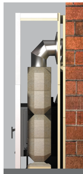
Prikaz preseka tri slojne konstrukcije zadnje stene
