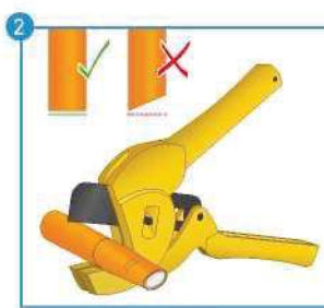
▲ Odrežite stisnjene konce cevi pod pravim kotom.
