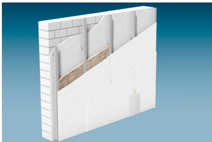
Sistemska konstrukcija W623 vsebuje podkonstrukcijo iz stropnih profilov CD, ki se pritrdijo na masivno steno z direktnimi ali akustičnimi obešali. Na tak način se realizirajo vitke oblage s poljubno višino. Obloga iz mavčnih plošč je eno- ali dvoslojna.
