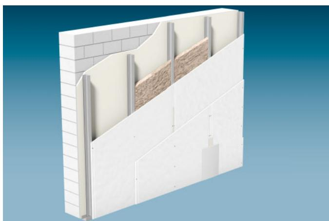
Sistemski konstrukciji stenskih oblog W625 in W626 vsebujeta stenske profile CW 50/75/100 in stojita samostojno pred masivno steno. Pri sistemu W625 je obloga iz mavčnih plošč enoslojna, pri sistemu W626 pa dvo- ali trislojna. Prosto stoječa konstrukcija stenske oblage ni povezana z masivno steno in omogoča realizacijo poljubno dimenzioniranega votlega prostora.
