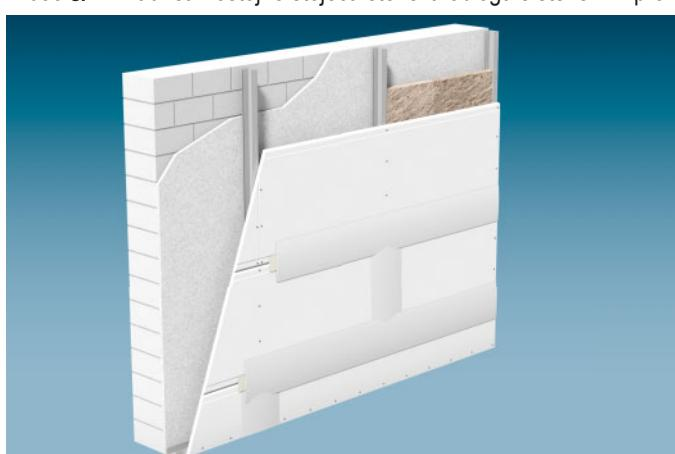
Sistemska konstrukcija W653 je konstrukcija iz kovinskih stenskih profilov CW 75/100. Stoji samostojno pred masivno steno. Oploščenje iz masivnih mavčnih plošč je enoslojno in poteka v horizontalni smeri. Zaradi samostojno stoječe konstrukcije – stenska obloga ni fizično povezana z masivno steno – lahko realiziramo poljubno dimenzioniran votli prostor. Zaradi masivnih mavčnih plošč lahko razmak med profili znaša do 1000 mm.
