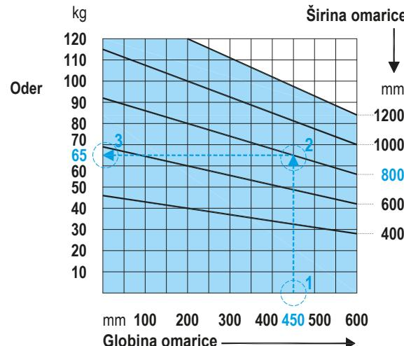
**Primer – Določitev dopustne teže omarice in določitev minimalnega števila pritrdilnih vijakov (vedno  $\geq 2$ )**
