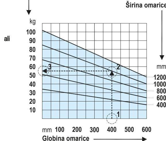
Do 0,7 kN/m (70 kg/m) dolžine stene: debelina oploščenja  $\geq 15$  mm Diamant /  $\geq 18$  mm Knauf mavčne plošče; PRIPOROČILO: uporabite profile  $\geq$  CW 75
