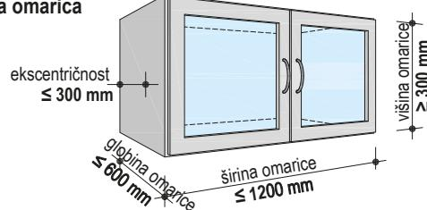
Do 0,4 kN/m (40 kg/m) dolžine stene: debelina oploščenja  $\geq 12,5$  mm Knauf mavčne plošče in Diamant
