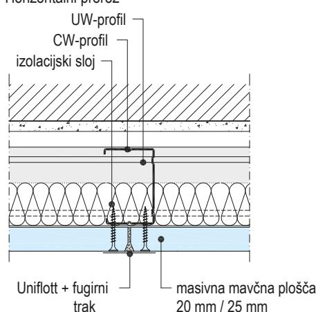
**Dilatacijske fuge****W623.si-BFU1 Dilatacijska fuga**
